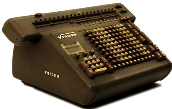
Una calcolatrice meccanica Friden SRW (1952), estraeva anche le radici quadrate
