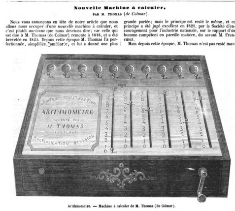
Arithmometre. — Machine à calculer de M. Thomas (de Colmar).
