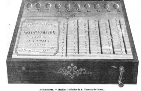
Arithmometre. — Machine à calculer de M. Thomas (de Colmar).
