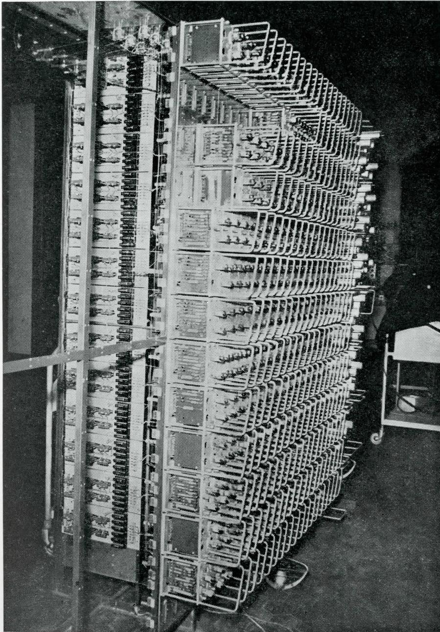
Fig. 2 - L'unità aritmetica della « Macchina Ridotta »
