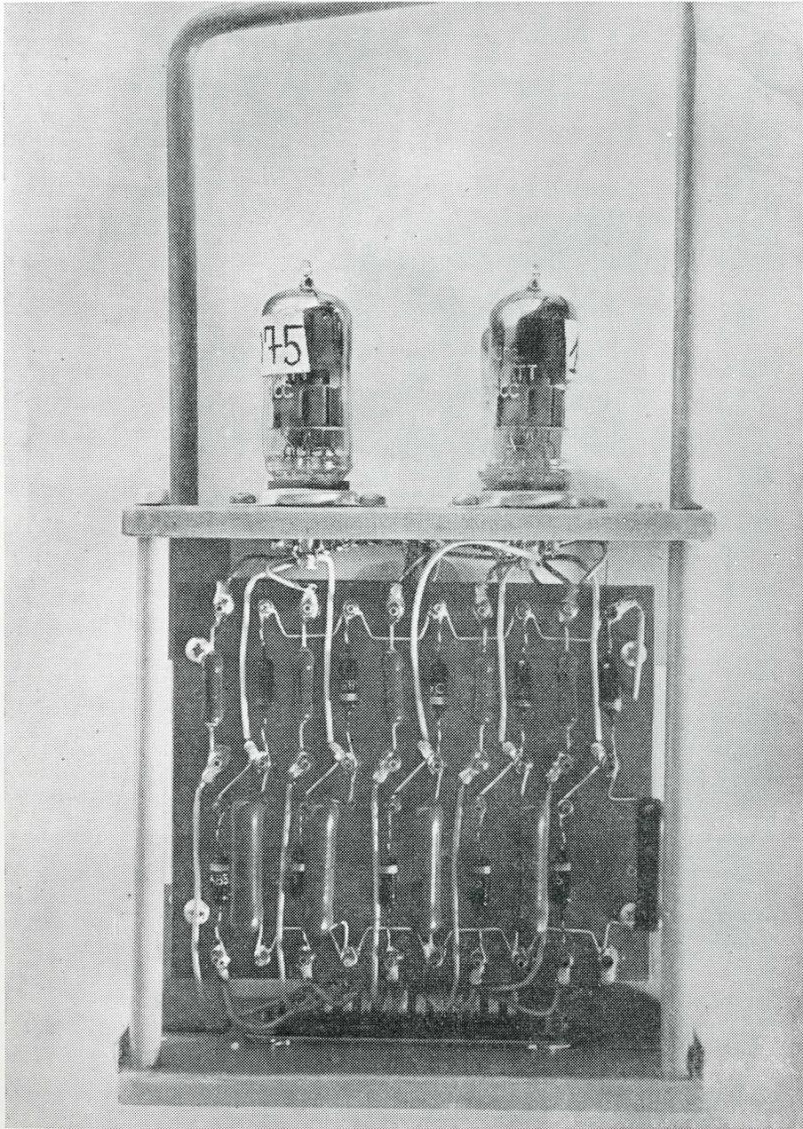
Fig. 5 - Châssis standard del commutatore
