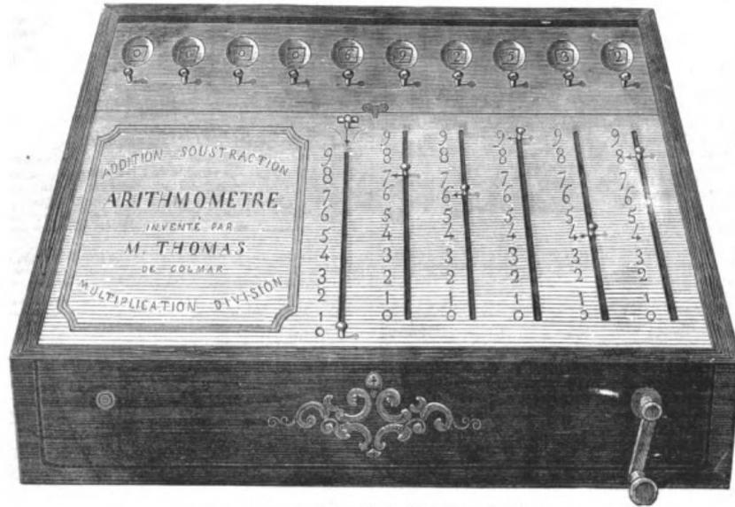
Arithmomètre. — Machine à calculer de M. Thomas (de Colmar).
